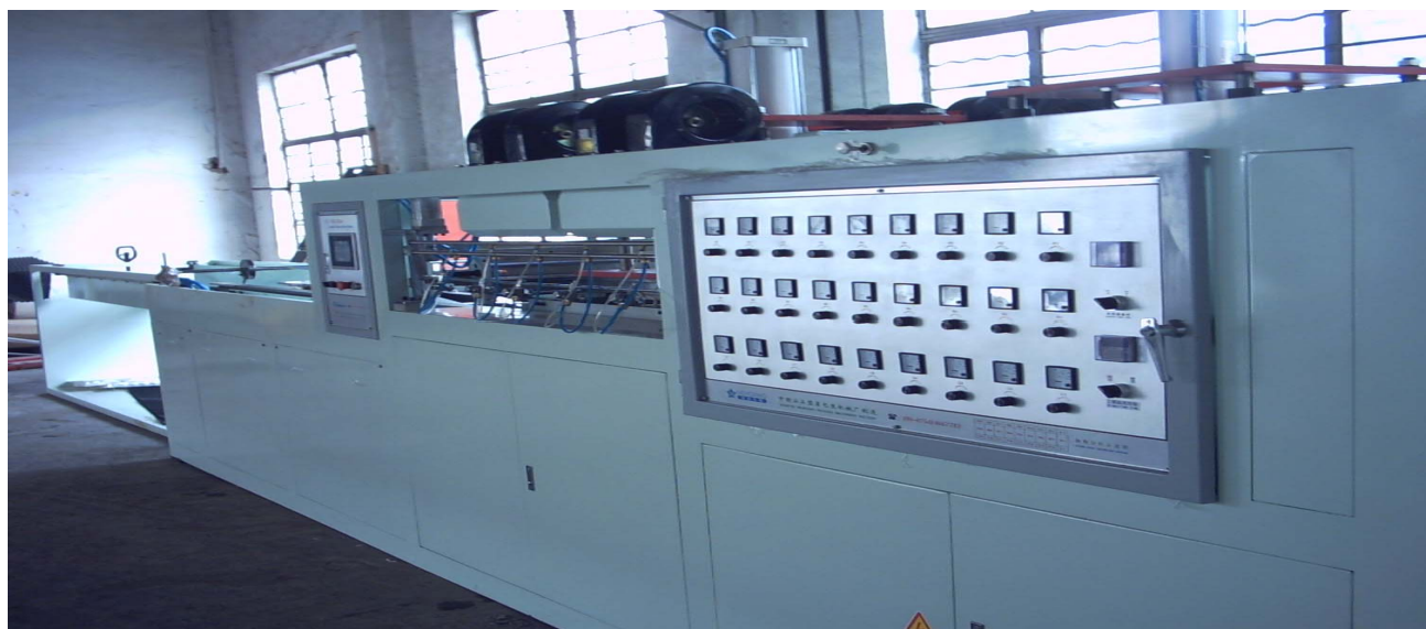
大型全自动填料真空吸塑成型机
